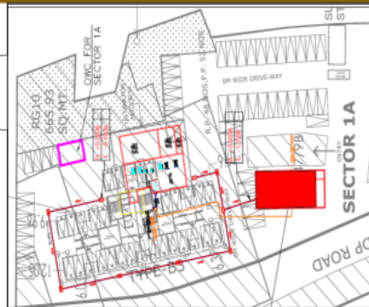
Sector 1A: STP: 120 KLD
